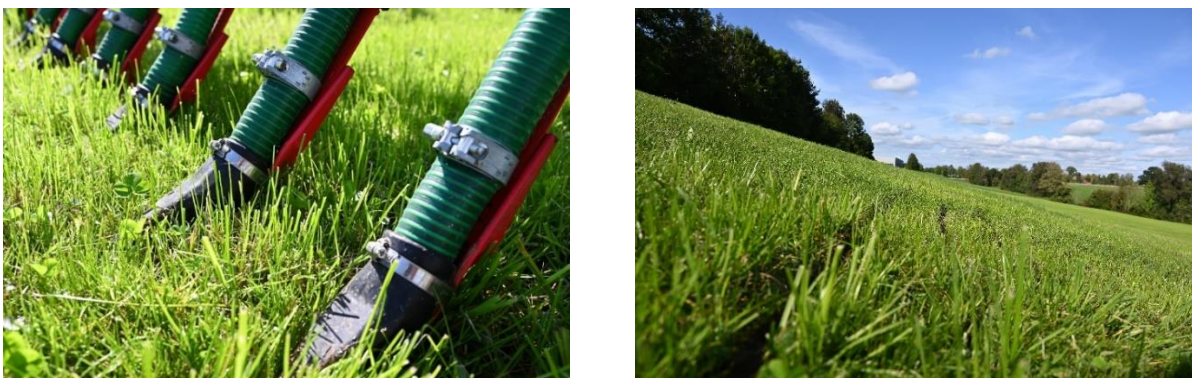
Abbildung 3: Ziel des Schleppschuhs: Ablage der Gülle unter den Pflanzenbestand auf den Boden (Bilder: LfL)
